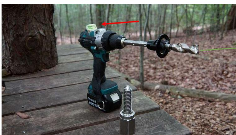
Die Position des Senkers und des Tiefenanschlages, kann durch Lösen der zwei **Madenschrauben** der Schraubenlänge angepasst werden.
