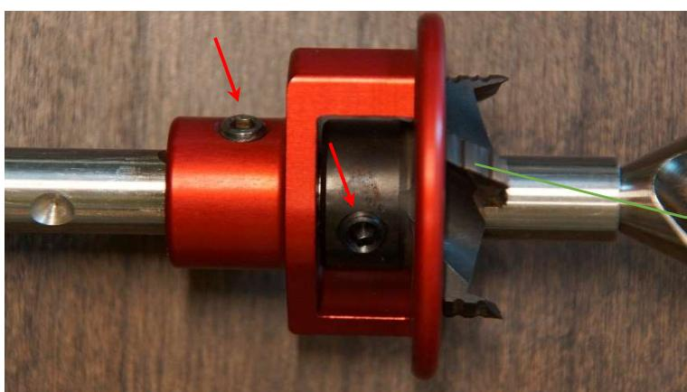
Die Position des Senkers und des Tiefenanschlages, in Abhängigkeit des Schraubentyps, festlegen.
