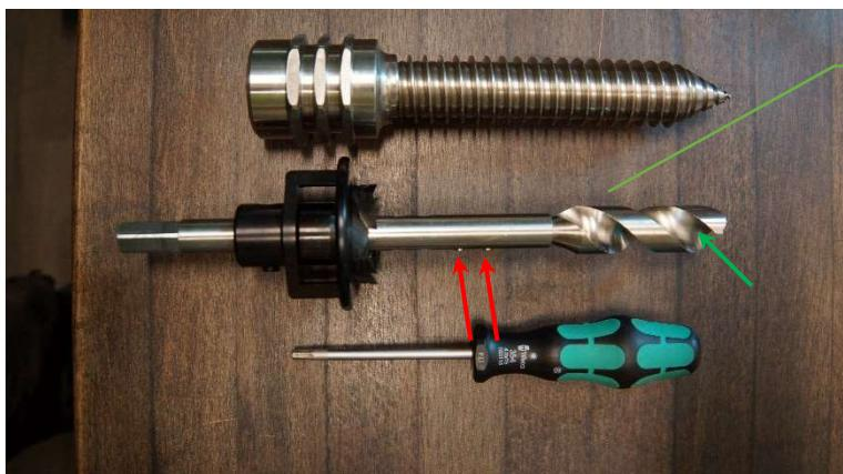
Auswählen des zur Schraube passenden Bohrdurchmessers.
