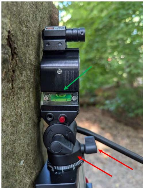
Nach dem Lösen der **zwei Klemmhebel** kann der Laser auf den Zielbaum ausgerichtet und die Bohrhülse ins **Wasser** gesetzt werden.
