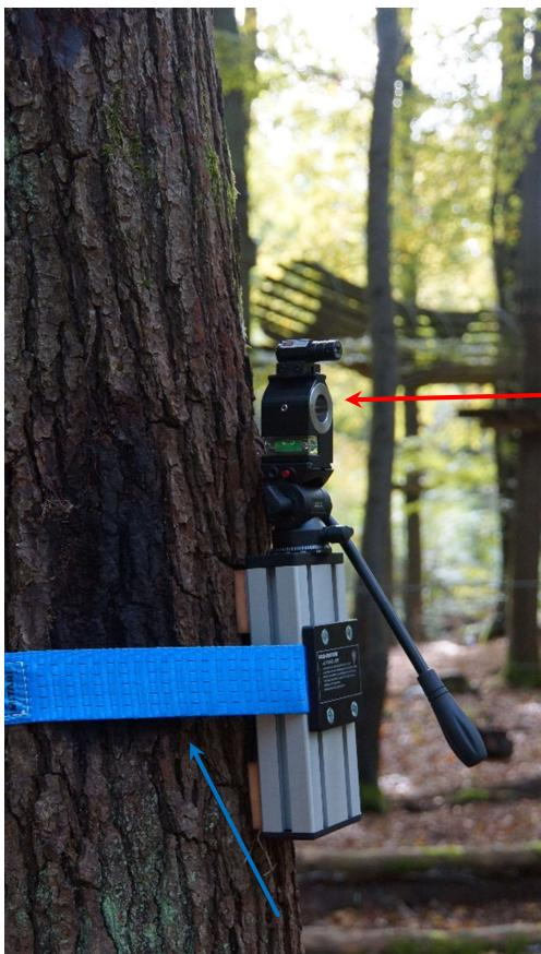
Anklemmen der Laserbohrvorrichtung mit **Zurrung**.
