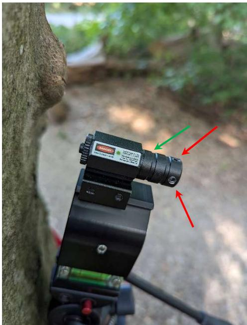
Kalibrieren des Ziellasers unter Zuhilfenahme eines Baulasers.
