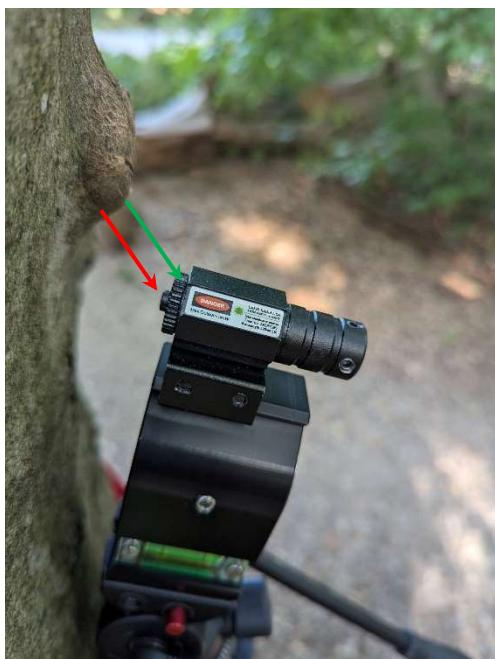
Zum Einsetzen der LR44 Batterien muss der **Einschaltknopf** mittels der **Rändelschraube** geöffnet und nach dem Einsetzen wieder geschlossen werden.
