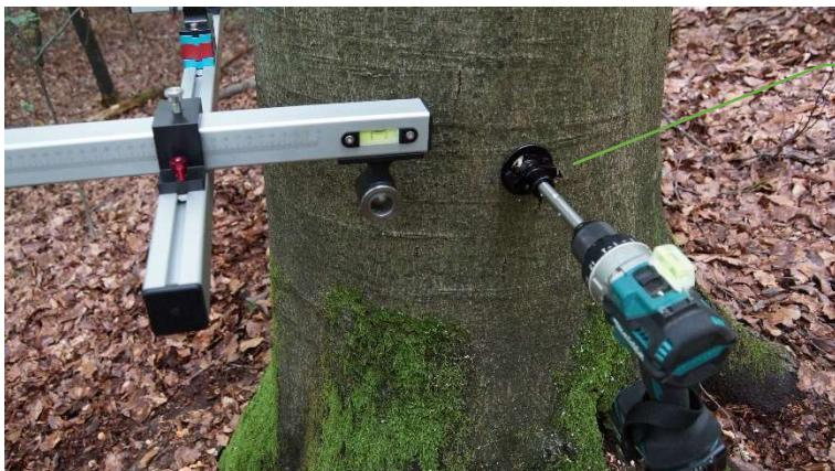
Den zweiten und dritten Plattformbolzen unter Beachtung der Einbauanleitung für Plattformbolzen (« Rev A // 06-06-2024 ») einbauen.
