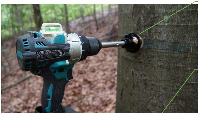
Den ersten Plattformbolzen unter Beachtung der Einbauanleitung für Plattformbolzen (« Rev A // 06-06-2024 ») einbauen.
