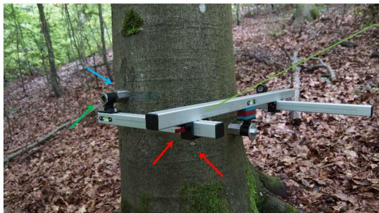
Klemmschrauben lösen und die Bohrhülse an der Plattformschraube ausrichten.
