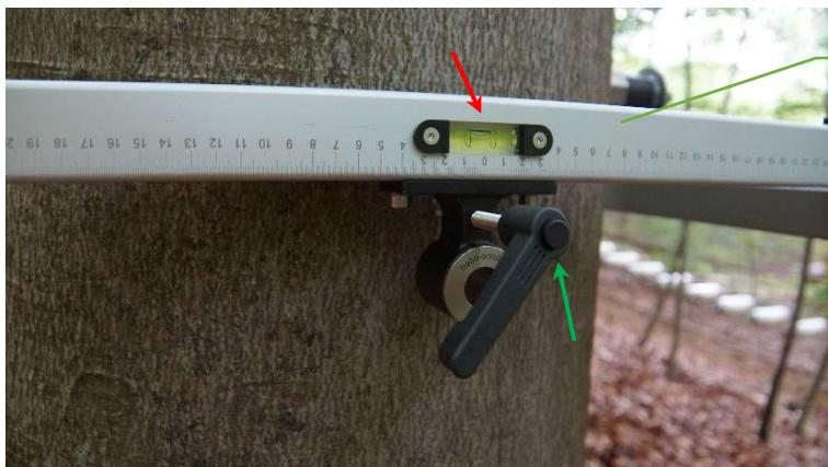
Seitenarme anhand der **Wasserwaagen** ausrichten und mit der **Zentriereinheit** am Stamm fixieren.
